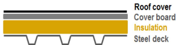
Rajah 4 : Gambaran lapisan penutup bumbung dan penebat bumbung yang tidak mudah terbakar
